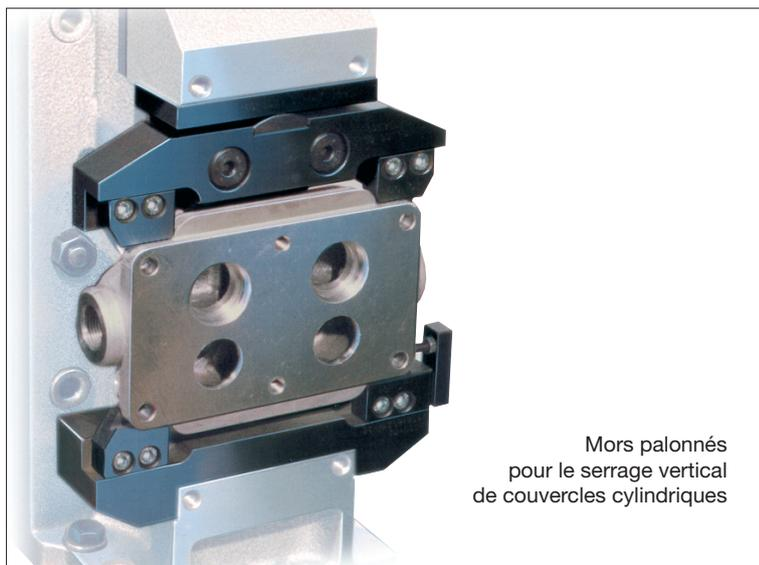
Mors palonnés pour le serrage vertical de couvercles cylindriques
