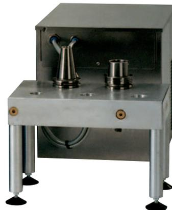
Grâce au système de refroidissement en ligne, le temps de refroidissement du porte-outil fretté ne dépasse pas 30 secondes. La table de refroidissement peut être adaptée aux diamètres spécifiques sur demande.
