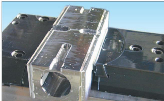
Mors à picots à effet de placage, mors mobiles avec insert palonné à effet de placage, compensation  $\pm 4^\circ$ , pour le serrage de pièces brutes.
