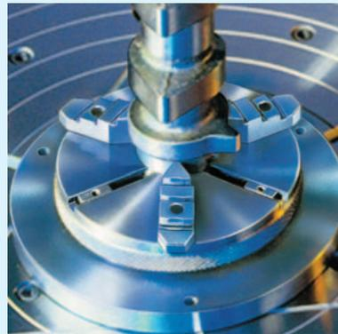
Mandrin 3 mors, pour le serrage de pièces rondes sur appareils de mesure
