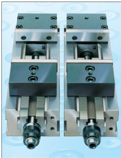
Le modèle étroit permet un montage cote à cote sur un faible encombrement. Ajustement précis de la hauteur  $\pm 0,01$  sur demande.
