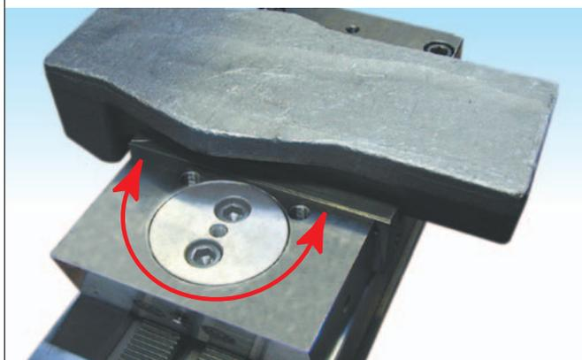
Mors de serrage à 4 appuis palonnés striés; compensation  $\pm 9^\circ$ , mors mobiles palonnés, sans effet de placage pour le serrage de pièces forgées.
