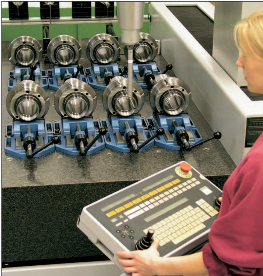
Serrage fiable et fixation de pièces à usiner sur perceuses et machines de mesure
