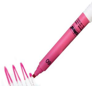
Les stylos de test, comme les encres de test, contiennent des liquides avec une tension de surface déterminée. Déterminez l'énergie de surface du matériau à contrôler en appliquant une marque avec le stylo.
