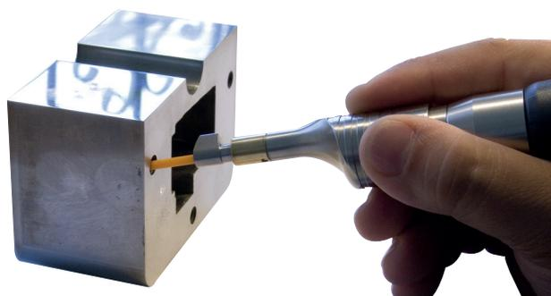
Une méthode tout à fait nouvelle pour le polissage de surfaces difficiles d'accès ou pour des travaux fins.
