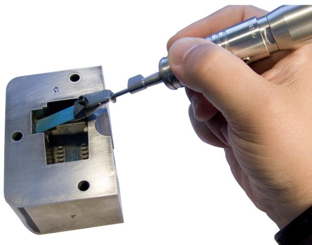
Ces têtes Mini-Lime ont une course transversale pour travailler les surfaces difficiles. Spécialement conçues pour les cols profonds. Avec une course variable entre 0 - 4 mm. Facile à régler à l'aide d'une clé hexagonale. Les petites dimensions permettent un meilleur contrôle et efficacité du polissage.
