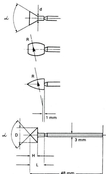
Les meules diamantées sont prévues pour travailler sur le carbure, l'acier trempé, le verre, les céramiques et autres matériaux similaires. Certaines formes sont particulièrement adaptées pour le travail de précision dans les trous borgnes et autres.
