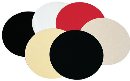
Généralement les disques de polissage de structure et de dureté différents sont utilisés, les uns après les autres, pour obtenir des polis miroirs des échantillons métallographiques. De la pâte de diamant de plus en plus fine sera appliquée sur les disques de polissage.
