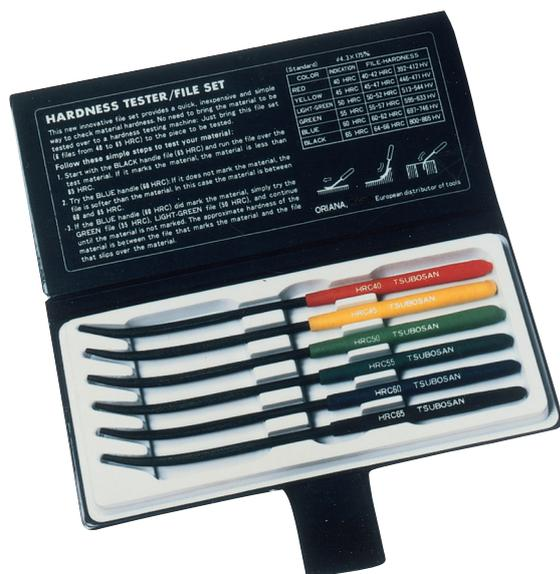
Ce jeu de limes permet de connaître, **rapidement**, la dureté des matériaux métalliques entre 40 et 65 Rc (Rockwell C) et 302 - 865 Vickers, avant les traitements mécaniques et après les traitements thermiques.
