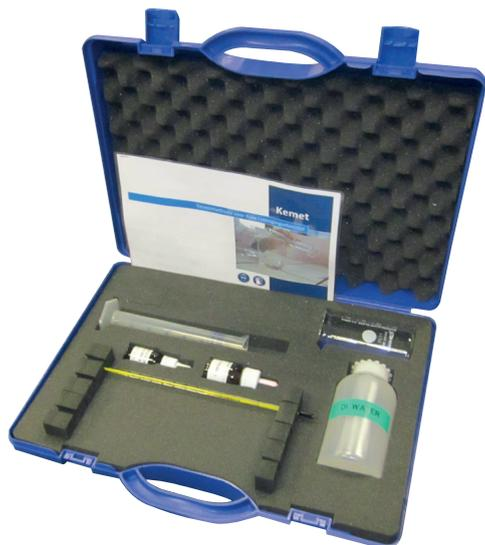
Un kit complet pour mesurer la concentration de détergent dans le bain de nettoyage. Ce kit est livré dans un coffret en plastique. Un mode d'emploi clair vous guide pas à pas dans le processus de titrage. Ce kit permet de faire environ 50 titrages.
