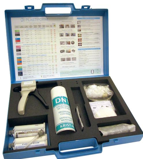
Ce kit d'inspection contient deux composants qui durcissent en les mélangeant (ratio 1:1). Le kit a été conçu spécialement pour le contrôle de surface visuel. Les utilisateurs sont les moulistes et les polisseurs. Le produit retranscrit très précisément tous les détails, les défauts de surface (marques d'outils, arrachement, fente, piqûre, stries...) et les défauts de forme (planéité, ondulation, circularité...)
