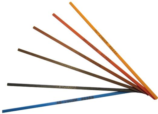
Batons céramiques à forte concentration de fibres croisées abrasives pour les travaux avec les appareils de polissage par ultrasons et les machines à limer. Spécialement conçus pour la finition des surfaces planes, des rayons, des arêtes et des nervures dans les moules. Conçus aussi pour des travaux d'ébavurage.
