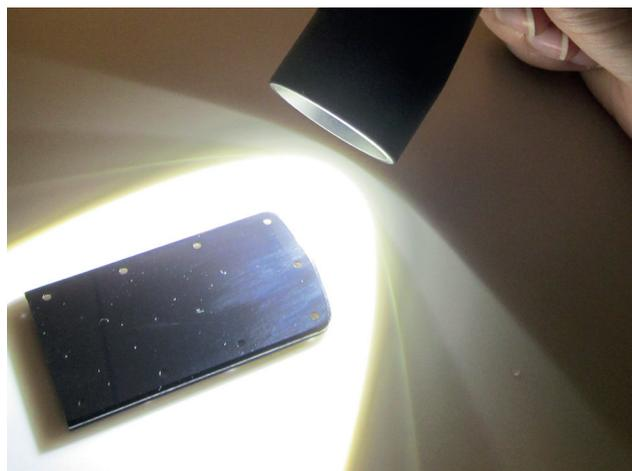
Lampe compacte. Pour la détection rapide et efficace de particules sur les surfaces de différents matériaux. Le faisceau fort permet une détection de très petites pollutions à l'oeil nu.
