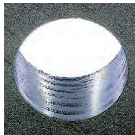
Diamètre du perçage : \varnothing = 6,35 mm CFK à couches unidirectionnelles avec une qualité optimale de l'usinage
